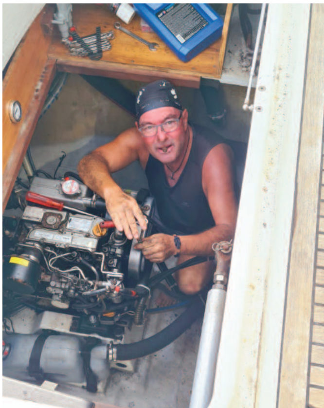
Changement des courroies sur les moteurs.
